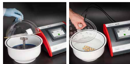
Test au colorant bleu de méthylène avec couvercle bombé
