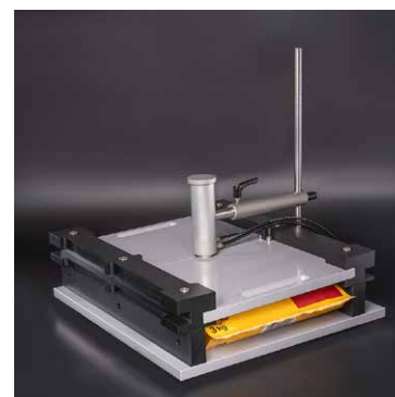
La plaque de retenue pour retenue ASTM F2054 - retient l'emballage pour assurer que la pression s'exerce de façon correcte sur les soudures de l'emballage
