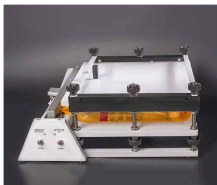
Le système de serrage pneumatique (PPC 300 II) - pour les tests d'éclatement sur la plupart des paquets, sacs ou pochettes ouverts d'un côté
